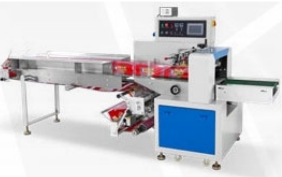
Confezionatrici flowpack con caricatore del rotolo di film inferiore (modelli X a sinistra) e superiore (modelli S in basso)
